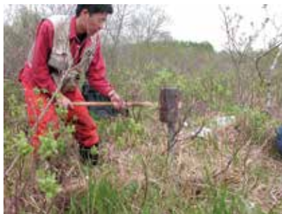
図3 調査時の様子. GPS による地形測量 (左)、水位計設置のためのパイプ打ち込み (中央)、設置した水位計 (右)。
