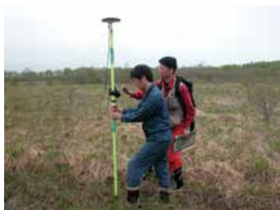
図3 調査時の様子. GPS による地形測量 (左)、水位計設置のためのパイプ打ち込み (中央)、設置した水位計 (右)。
