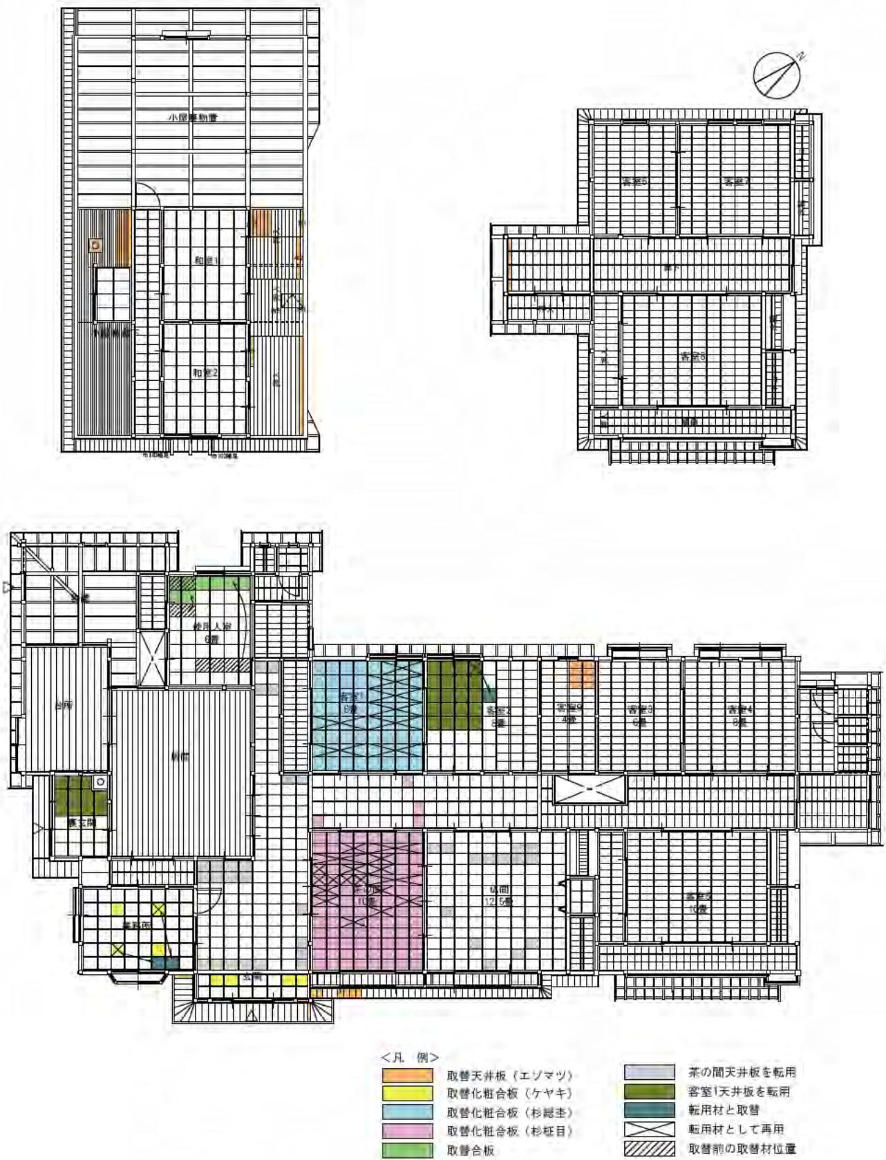
図 5-10 天井補修範囲図 (上:二階, 下:一階)
