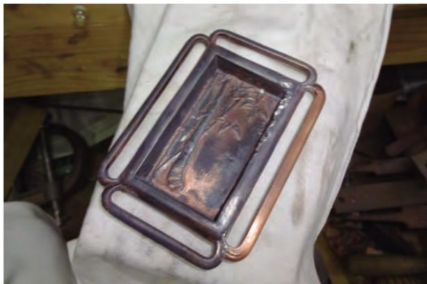
欠損部半田接合完了
