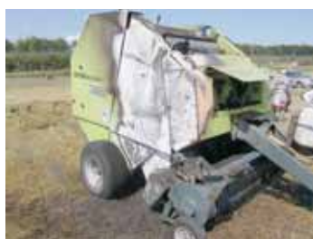
◀作業中のロールベアラーから出火
