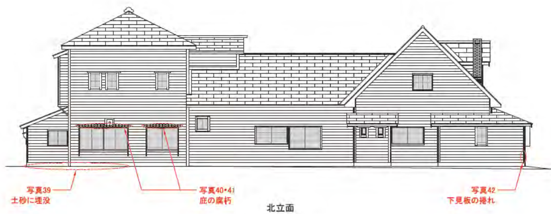
図5 外部破損箇所1
