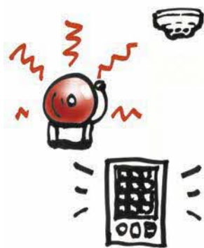
自動火災報知設備
