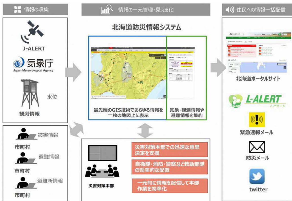
別図1 北海道防災情報システム（Lアラート）の概念図
